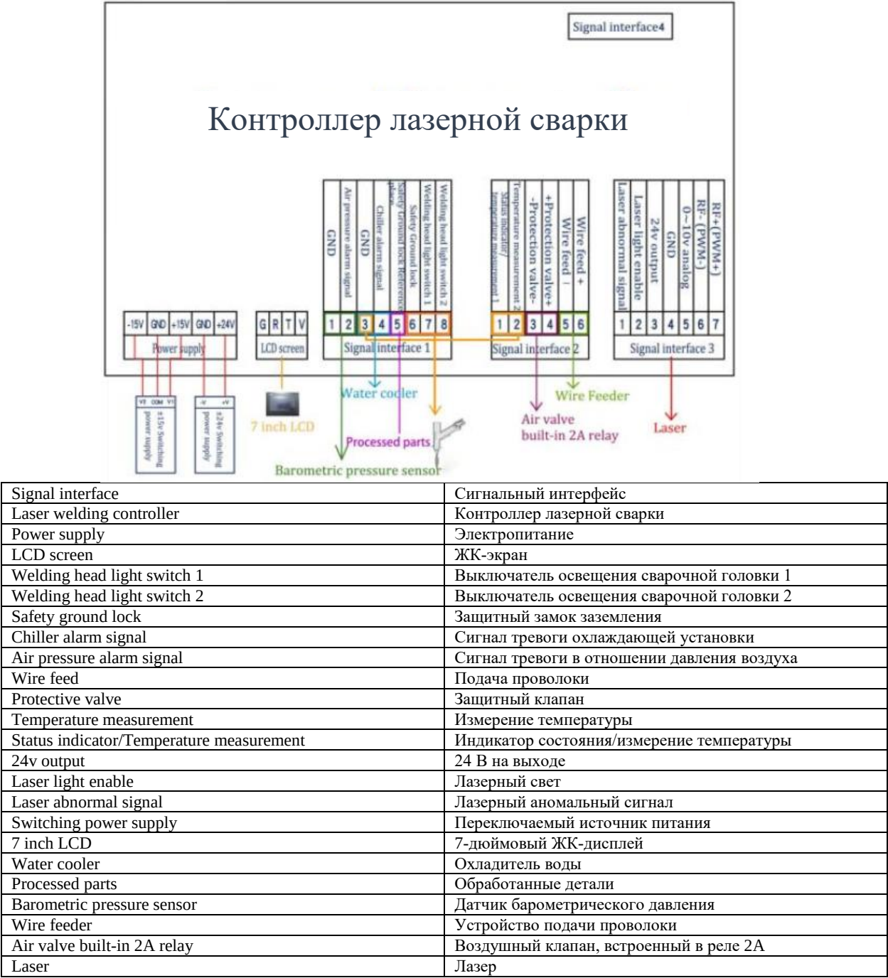
Рисунок 2.1 Схема клеммного блока контроллера
